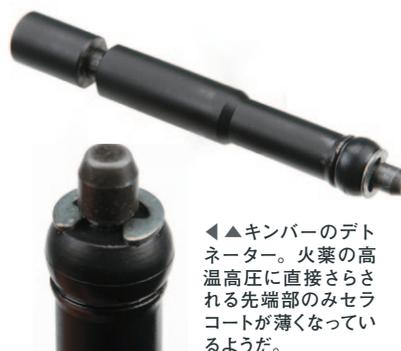
◀◀キンバーのデトネーター。火薬の高温高压に直接さらされる先端部のみセラコートが薄くなっているようだ。
