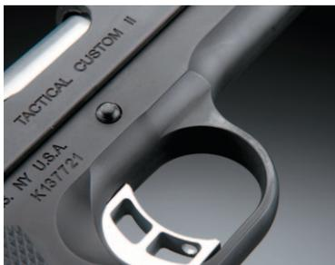
▲トリガーガード側面にもかなり跡が付いたが全く剥がれる気配がない。コーティングが薄く圧縮されている感じが分かるだろうか。
