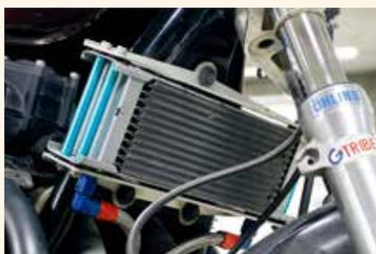
④セラコートが持つ放熱性の高さを活かし、オイルクーラーやラジエーターをコーティングするのもひとつの方法だ。カラーも選べるため、ネイキッドモデルではドレスアップとしても有効になる
