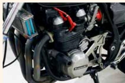
④空冷エンジンや油冷エンジンではフィンに走行風をあてて冷却している。そのため放熱性の高いセラコートをほどこすことは有効だろう。ただし耐熱温度の関係で、色の選択は少ない
