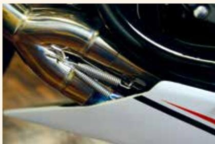
④エンジンやマフラーから発する熱により、カウルが変形してしまったり、フレームが熱せられることもある。それを防ぐために、断熱効果の高いセラコートで仕上げることは有効な方法のひとつといえる
