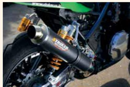
④エキゾーストパイプほど温度は上がらないが、サイレンサーをセラコートで仕上げるのもありだろう。断熱性・放熱性が高まるだけでなく、数多い色が設定されているため、ドレスアップ効果も高い
