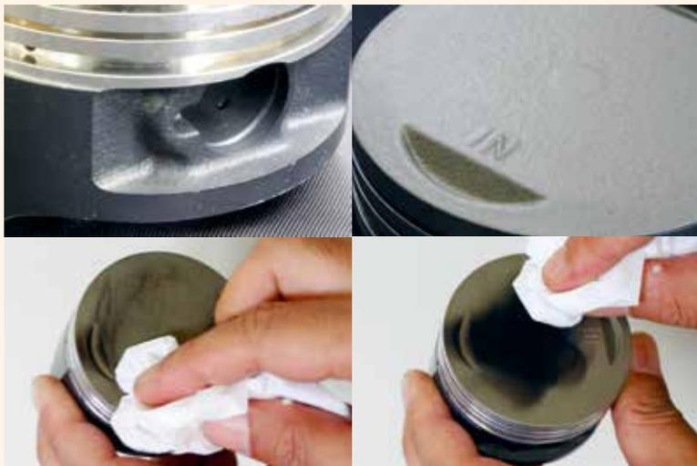
④このピストンにはトップに耐熱温度の高いセラコートが、サイドにはマイクロスリックと呼ばれるセラコートがほどこされている。トップ部分はライダーであれば黒くなるが、ティッシュで拭き取ると簡単に除去できた。母材を守るだけでなく、カーボン堆積の防止が期待できる。また、サイド部はフリクションロス低減がねえ、どころも塗装感覚で施工できるのもポイントだという
